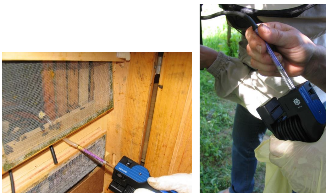
Slika 7: Merjenje hlapov mravljinčne kisline z ročno črpalko in indikatorsko cevko
