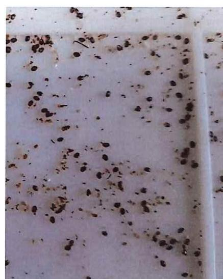
Slika 4: Štetje odpadlih varoj na testni podnici
