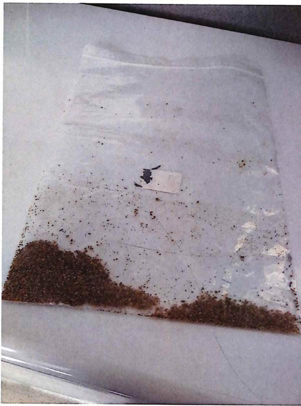
*Slika 2: Vzorec drobirja v vrečki za vzorčenje*
