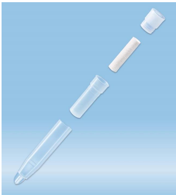
Slika 2: Razstavljen komplet epruvete Salivette s sintetičnim zvitkom (bel del na sliki), ki smo ga prijeli s peanom in pomočili v ingver v prahu
